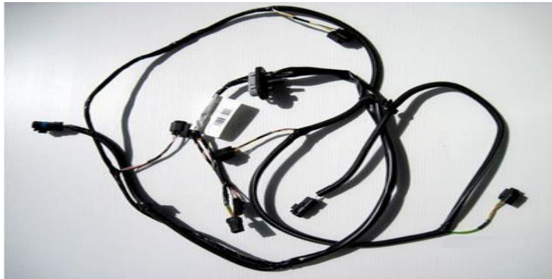
Figure 5 : Exemple d'un faisceau électrique
