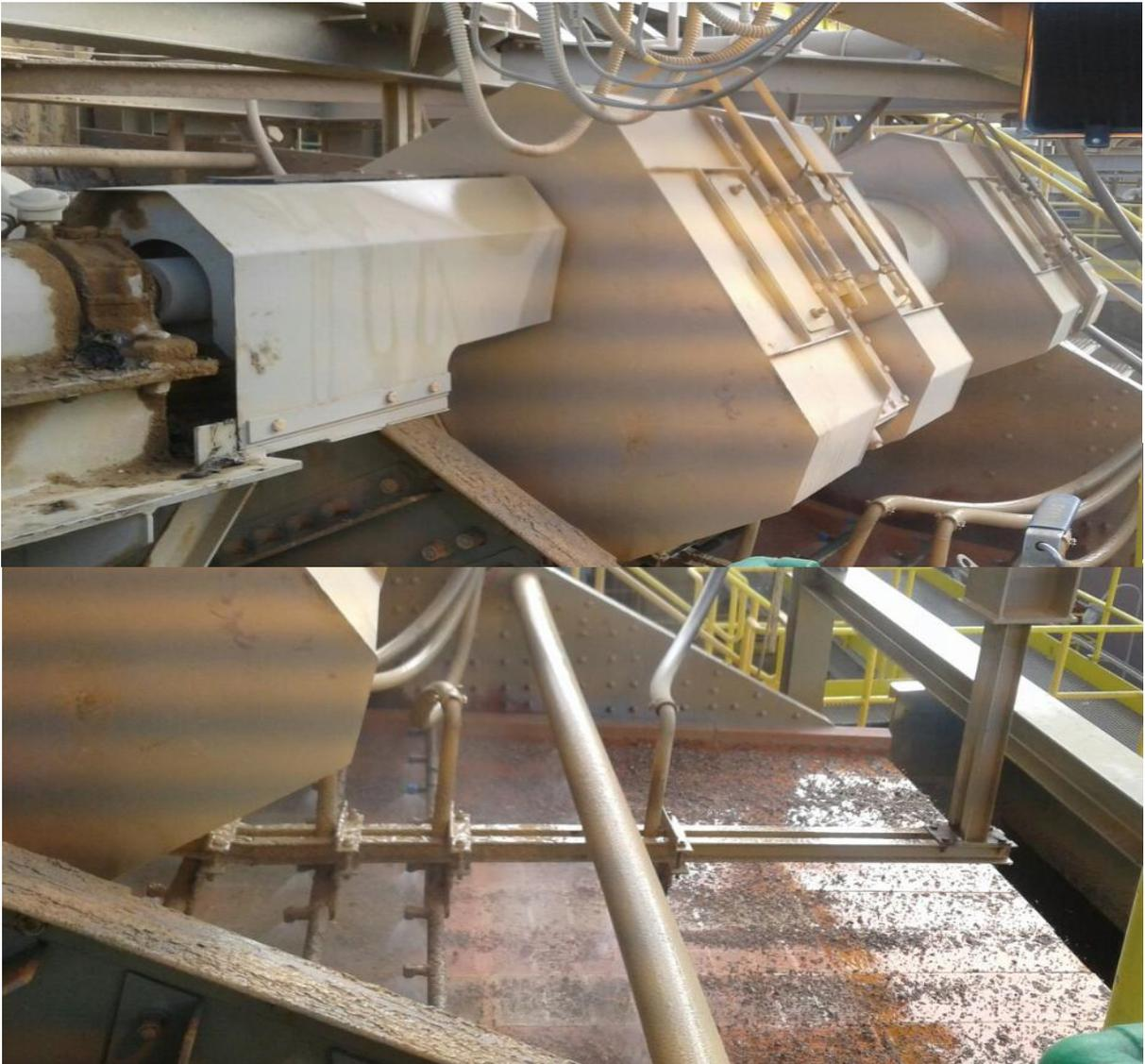
Figure 16 : Crible vibrant
