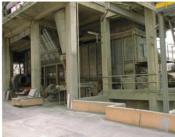
A la sortie du four, le clinker va progresser à l'intérieur du refroidisseur grâce aux couts répétés des grilles sur lesquelles il repose. A travers ces grilles, de puissants ventilateurs vont
