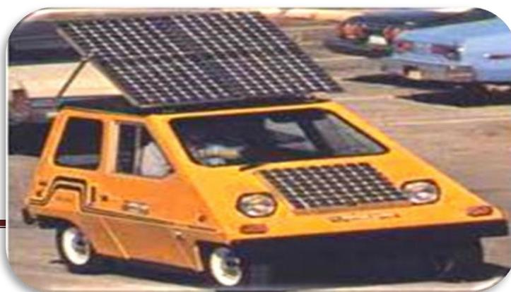
Figure 7 : Première voiture alimentée par énergie photovoltaïque (1983)
