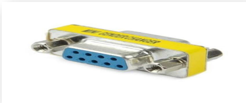
Figure 37 : Connecteur RS232 à 9 voies
