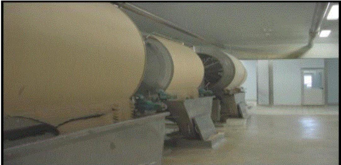
**Figure 3 : Filtre Rotatif**
