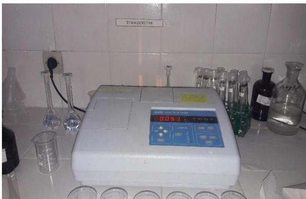
Figure 8 : Turbidimètre
