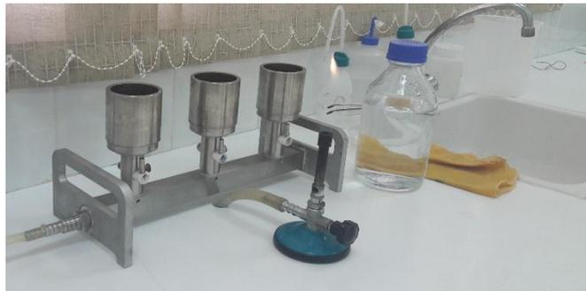
Figure 13 : Méthode de la membrane filtrante (bec benzène-entonnoirs- pompe à vide)
