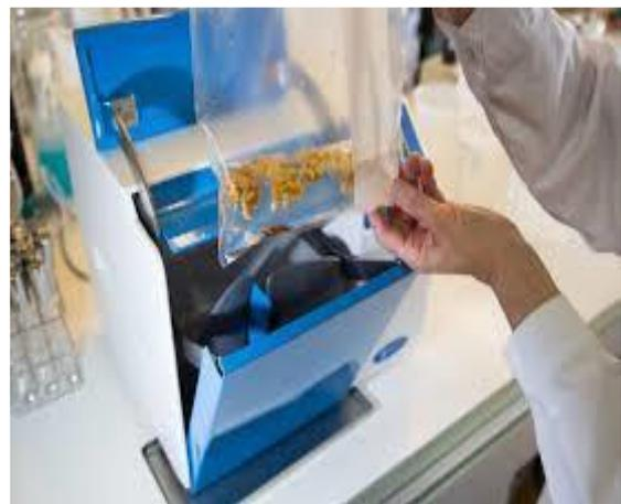
**Figure 4 : L'homogénéisation pendant 30s au Stomacher**
