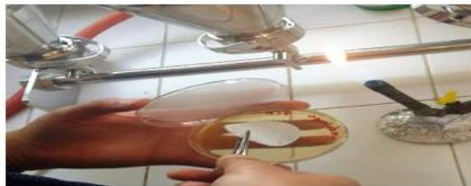
**Figure 10** : mise en culture du filtre sur milieu de culture PCA
