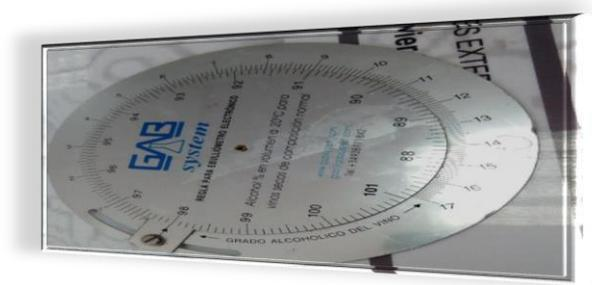
Figure 29 : Disque du degré d'alcool
