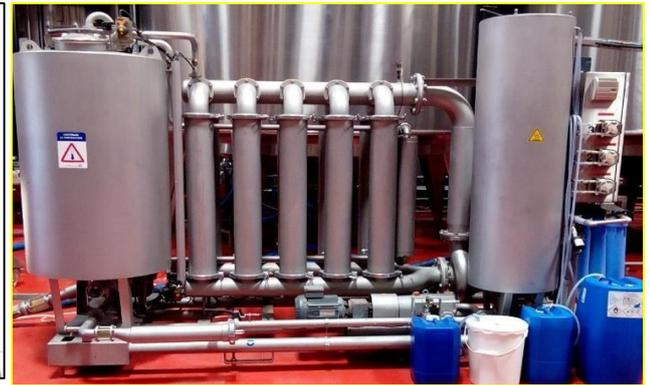
Figure 13 : Filtre tangential
