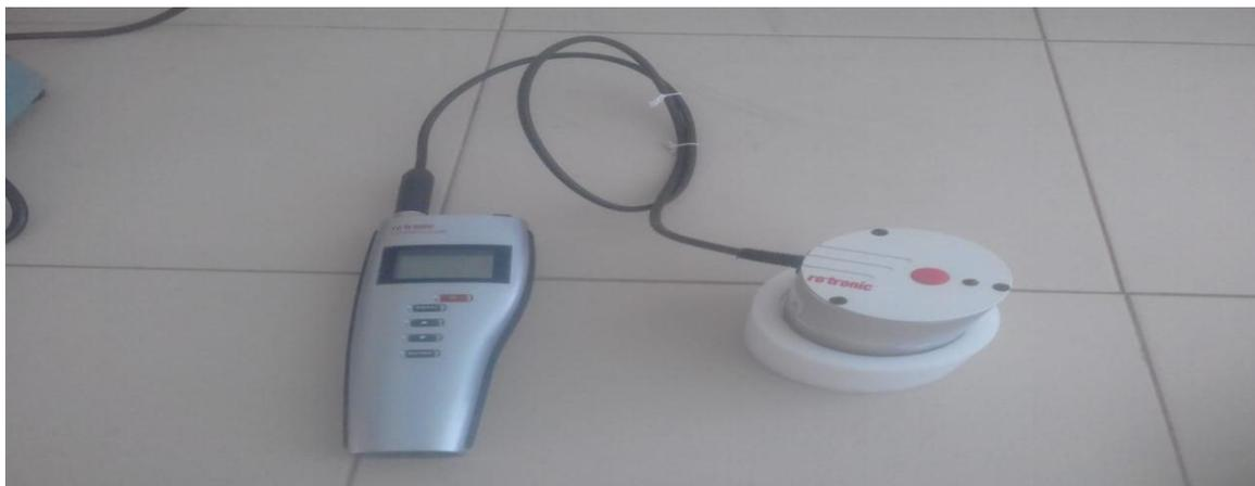
Figure 2 : Appareil mesure l'Aw directement
