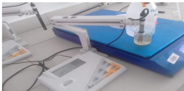
**Figure 5 : conductivimètre**
