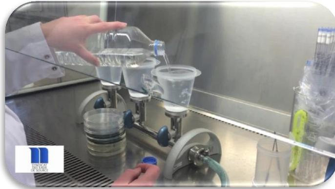
Figure 8 : appareil de filtration sur membrane
