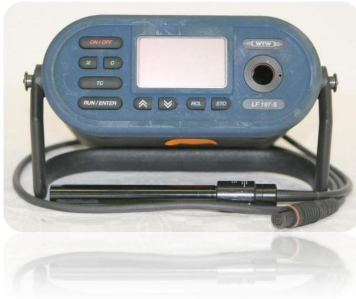
**Figure 8** : Photo d'un conductimètre.
