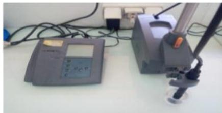
**Figure 3 : Conductimètre (Cond 7310).**
