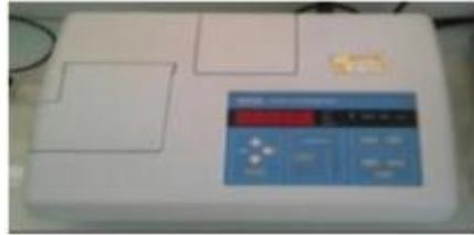
**Figure 2 : Turbidimètre (HACH 2100N)**
