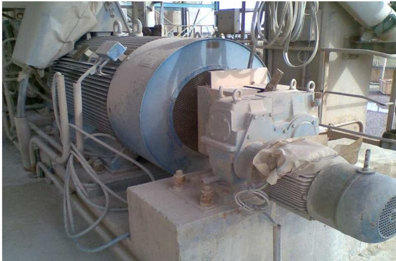
**Figure 13 : Le moteur principal et le vireur du broyeur**
