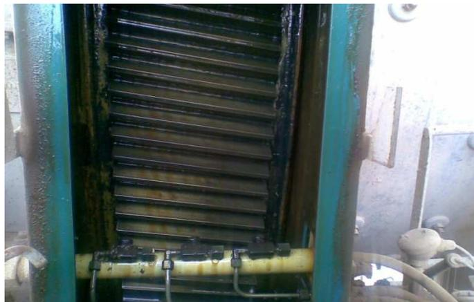
**Figure 14 : la couronne d'entrée et le système de graissage**
