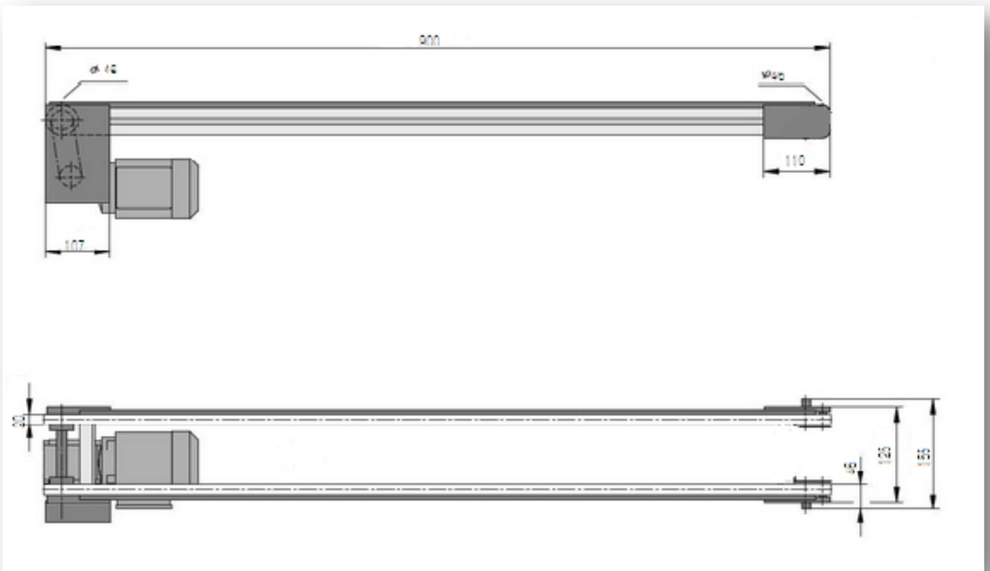
**Figure 17:** dessin d'ensemble du convoyeur à double bande
