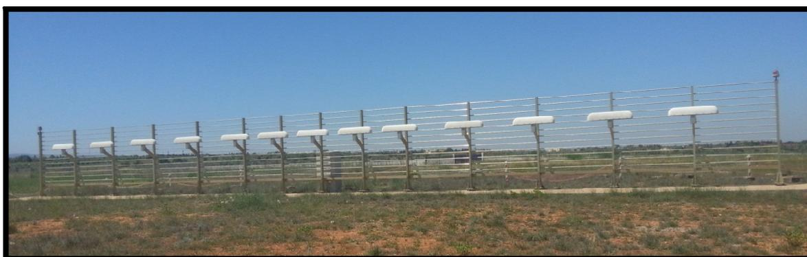
*Figure 7 : les antennes d'un Localizer*
