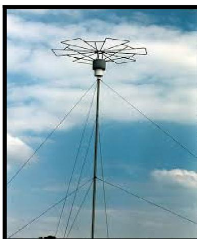
Figure 17: Antenne de la balise NDB
