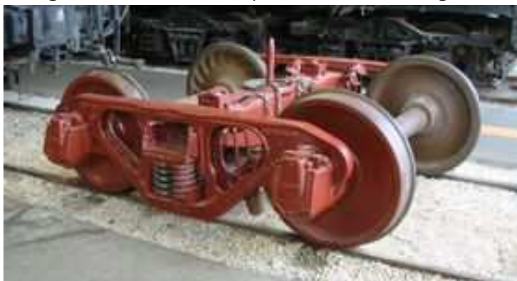
Figure 5 : un bogie qui comporte deux essieux
