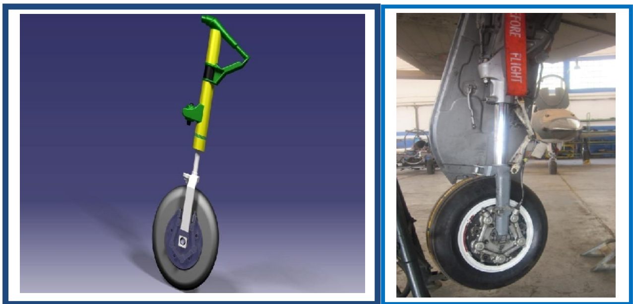
Figure 17 : Le modèle réel et géométrique du bloc frein
