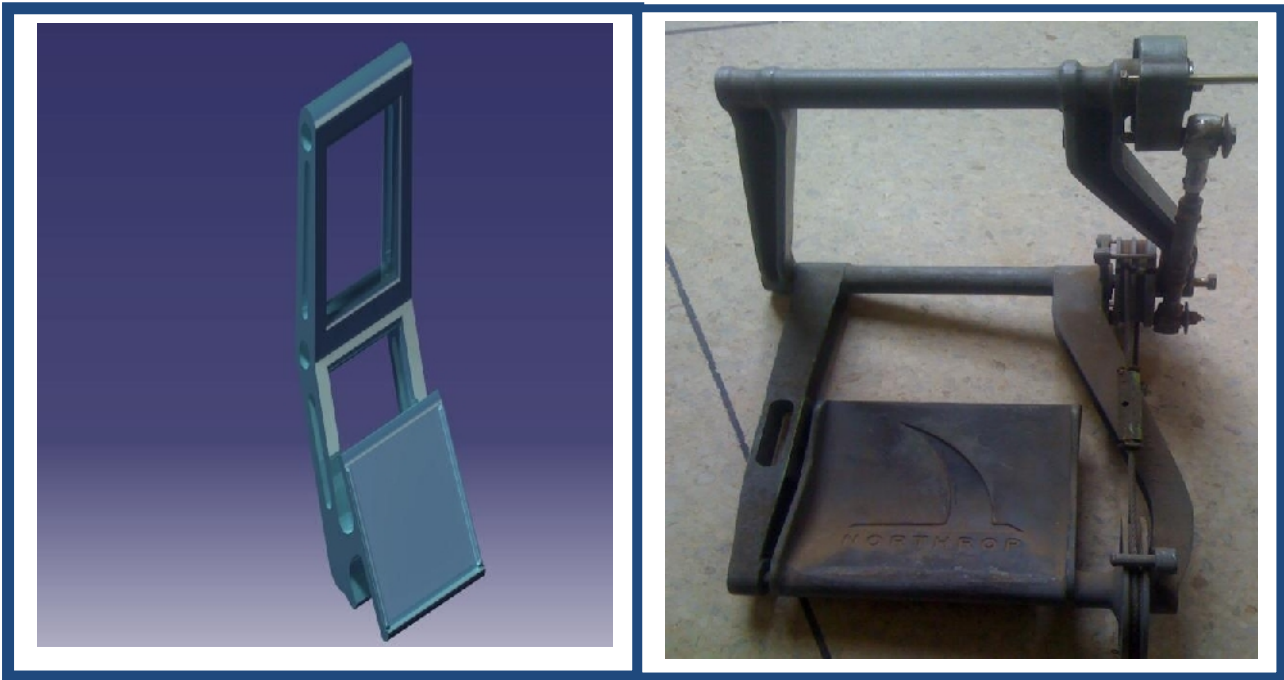
Figure 15 : Le modèle réel et géométrique de la pédale
