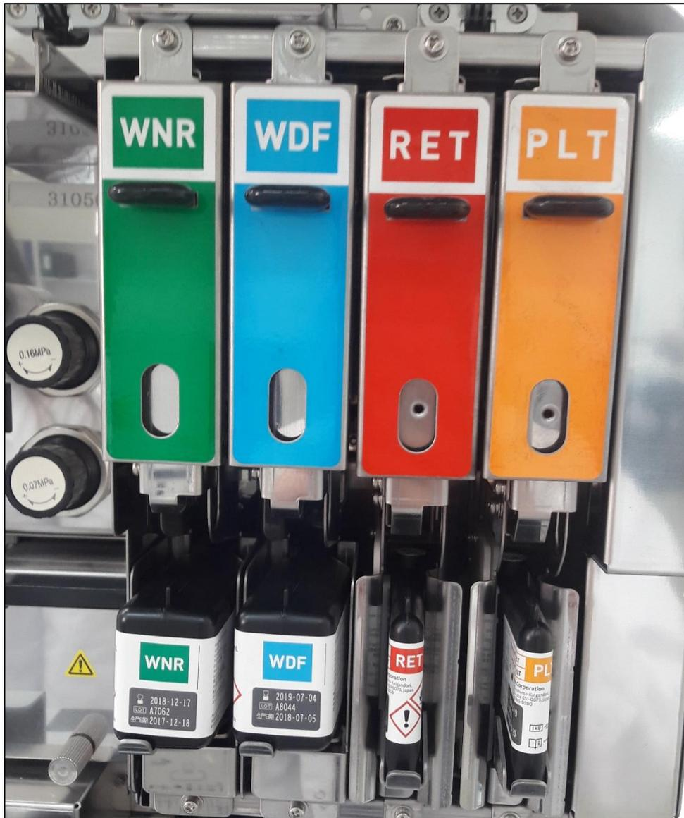
**Figure 12 : Les réactifs utilisés par l'analyseur d'hémogramme pour la réalisation de la numération formule sanguine.**
