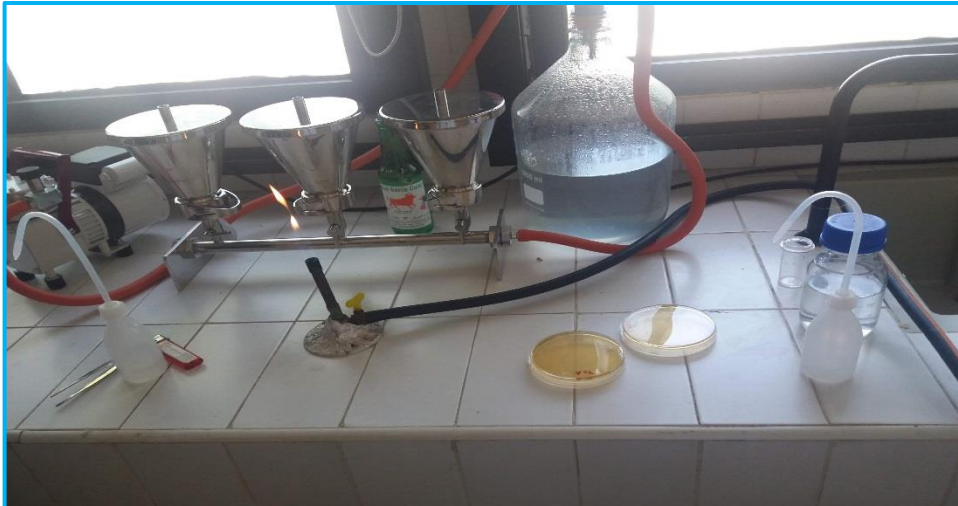
Figure 15 : Poste de filtration du prélèvement endoscopique
