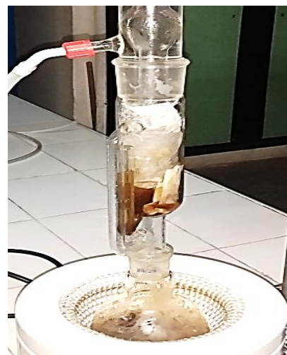
Figure 4: Montage d'extraction par Soxhlet. à gauche l'extraction méthanolique, à droite l'extraction aqueuse
