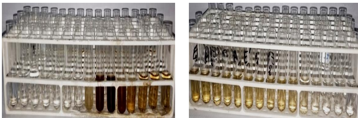
Figure20 : Fractions séparées par chromatographie d'exclusion d'extrait aqueux
