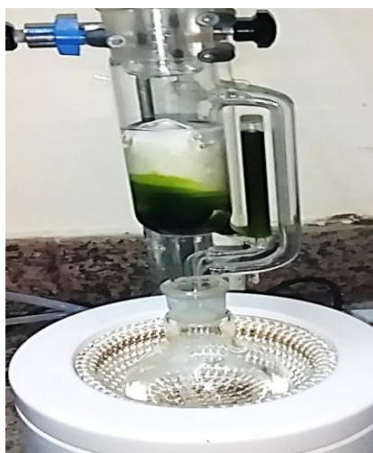
Figure 4: Montage d'extraction par Soxhlet. à gauche l'extraction méthanolique, à droite l'extraction aqueuse
