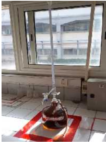
Figure 7 : Titrage de l'acide libre par \text{BaCl}_2
