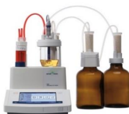
Figure 11 : Appareil Titrateur volumétrique Karl Fischer METTLER TOLEDO DL 38.
