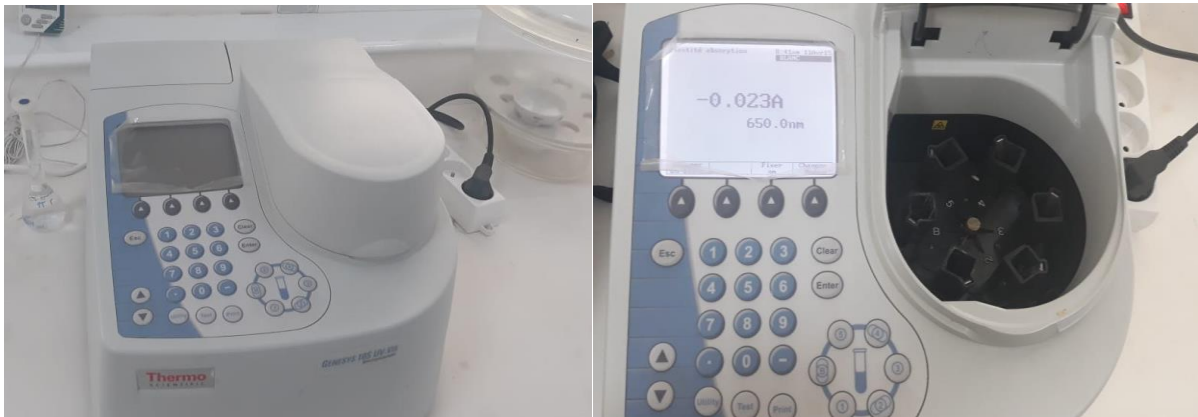
Figure 7: spectrophotomètre UV-visible à mono faisceau.
