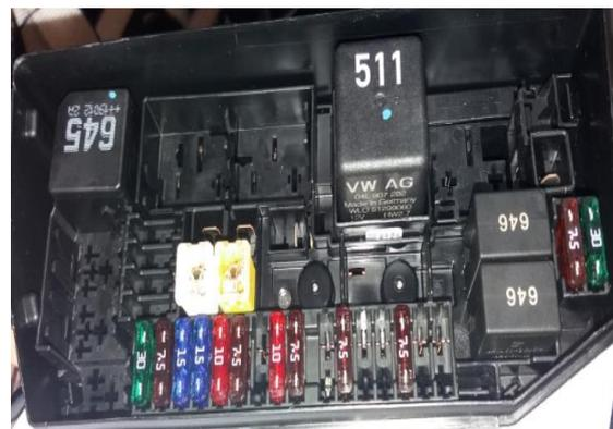
Figure 20 : Le connecteur EMBOX avec ses relais et fusibles
