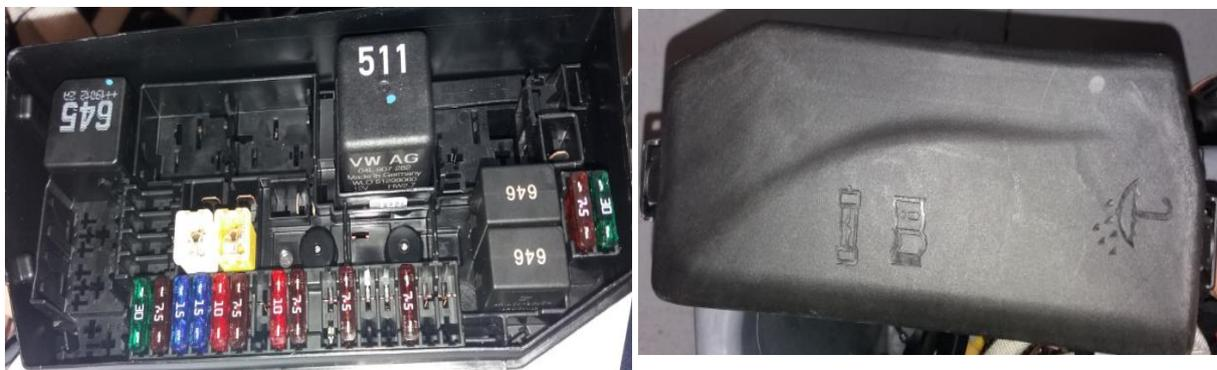
Figure 23 : Le connecteur EMBOX inséré dans sa boîte plastique
