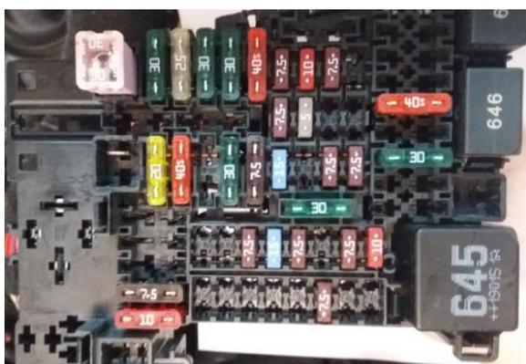
Figure 21 : Le connecteur LVI avec ses relais et fusibles
