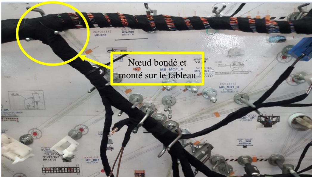
Figure 14 : Nœud principale bondé et monté sur le tableau
