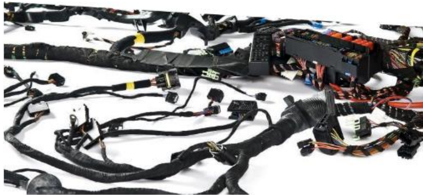
Figure 5 : Exemple de faisceau électrique (câble principale)
