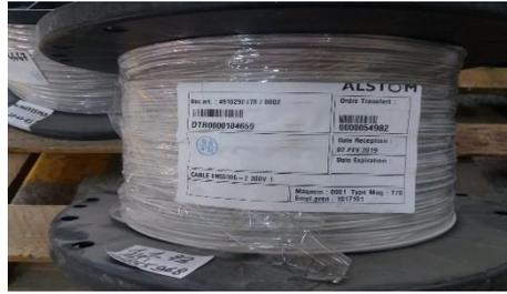
Figure 43: Bobine bien identifiée avec le code DTR.
