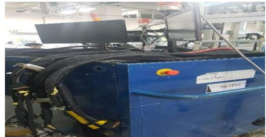
Figure 14: Machine de test des câbles
