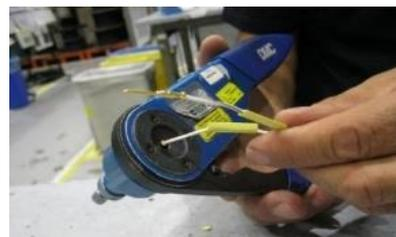
Figure 11: Opération de dénudage et sertissage
