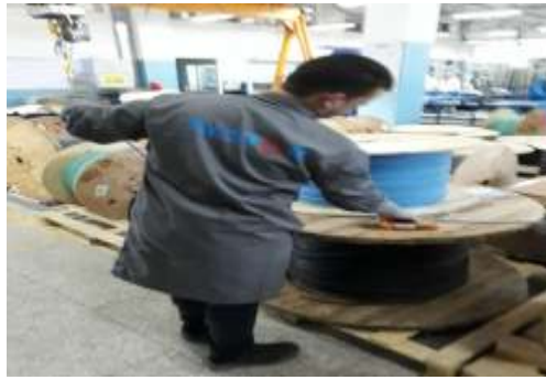
Figure 27:défilement des câbles pour la coupe manuelle
