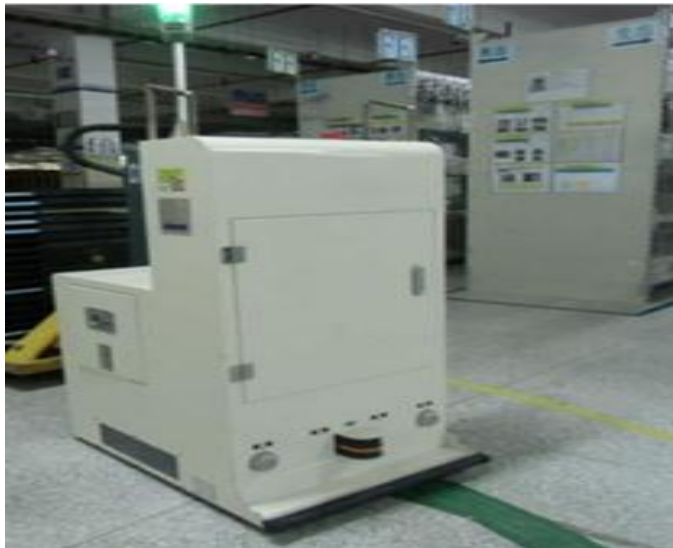
Figure 23: AGV sur le terrain de l'entreprise
