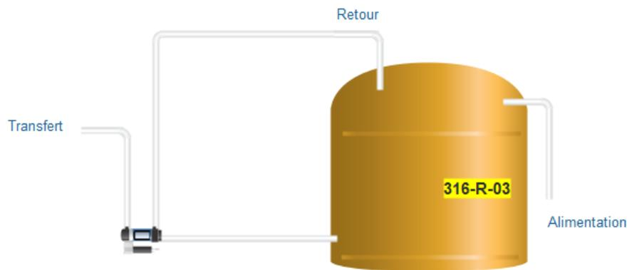
Figure 27 : schéma de circulation externe d'acide sulfurique
