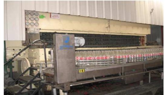
Figure 10 : Photo de la laveuse des bouteilles à la CBGN
