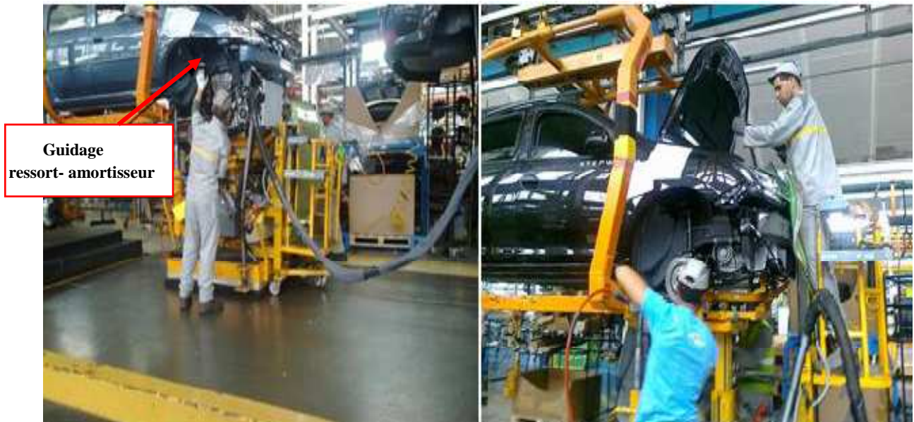
Figure 13 : Guidage des ressort-amortisseurs et fixations de berceau
