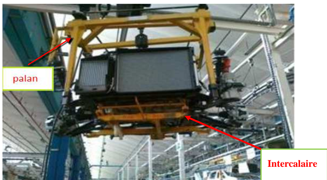
Figure 12: Levage de GMP par le palan
