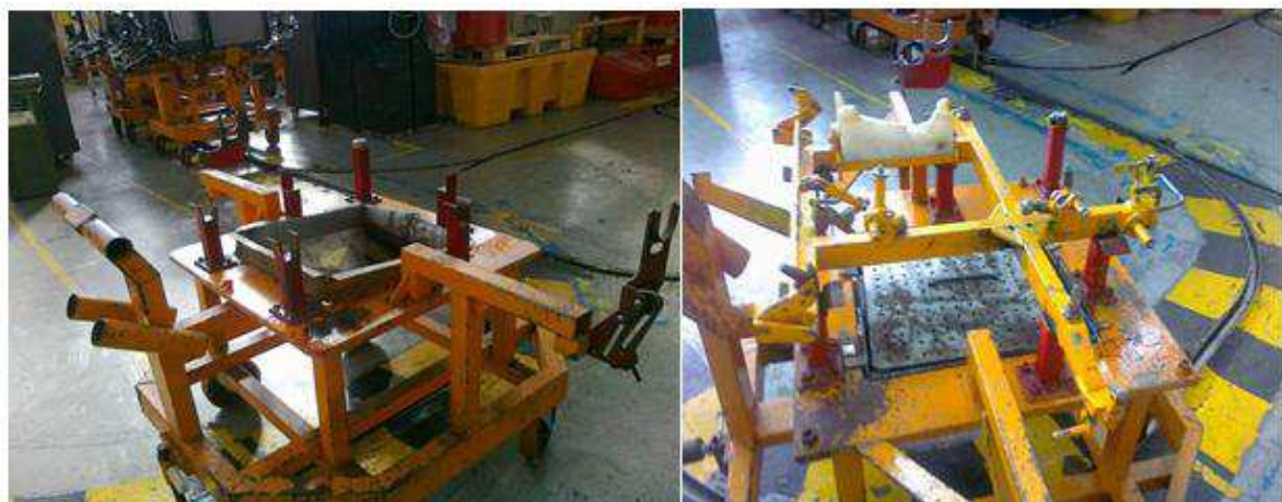
Figure 14 : Positionnement de l'intercalaire sur le chariot de préparation
