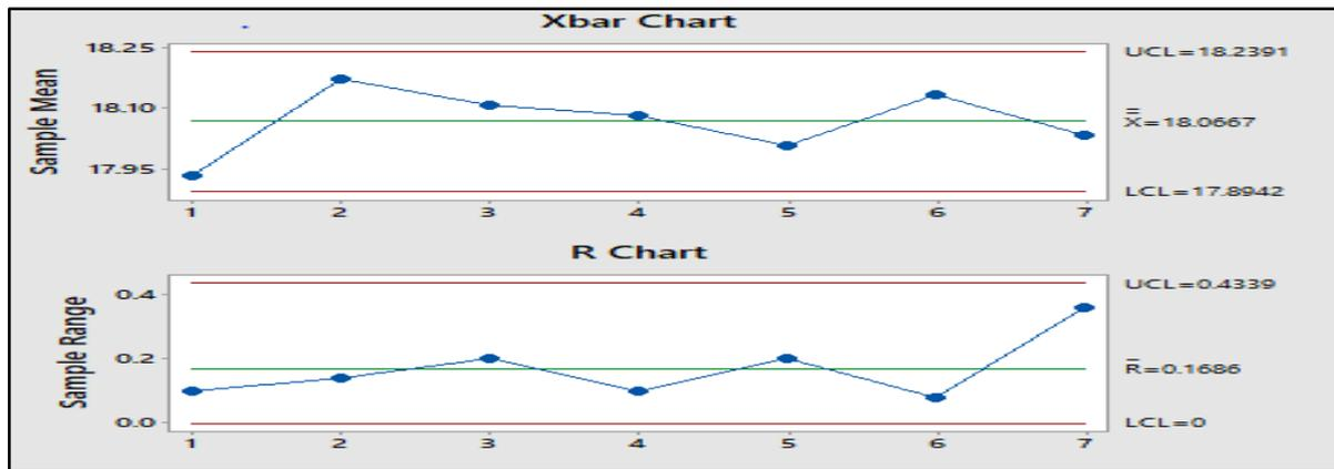
Figure 29 : Carte de contrôle de moyenne et d'étendue pour P<sub>2</sub>O<sub>5</sub>.
