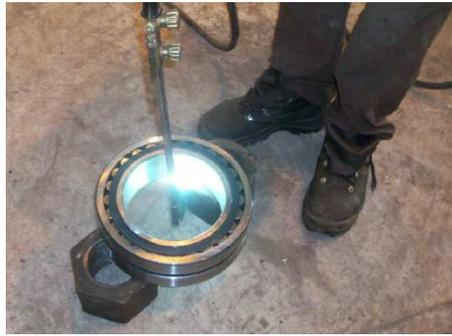
(Fig.19) : chauffage de roulement
