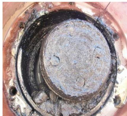
Fig. (7) : roulement Palier droit défaillant
