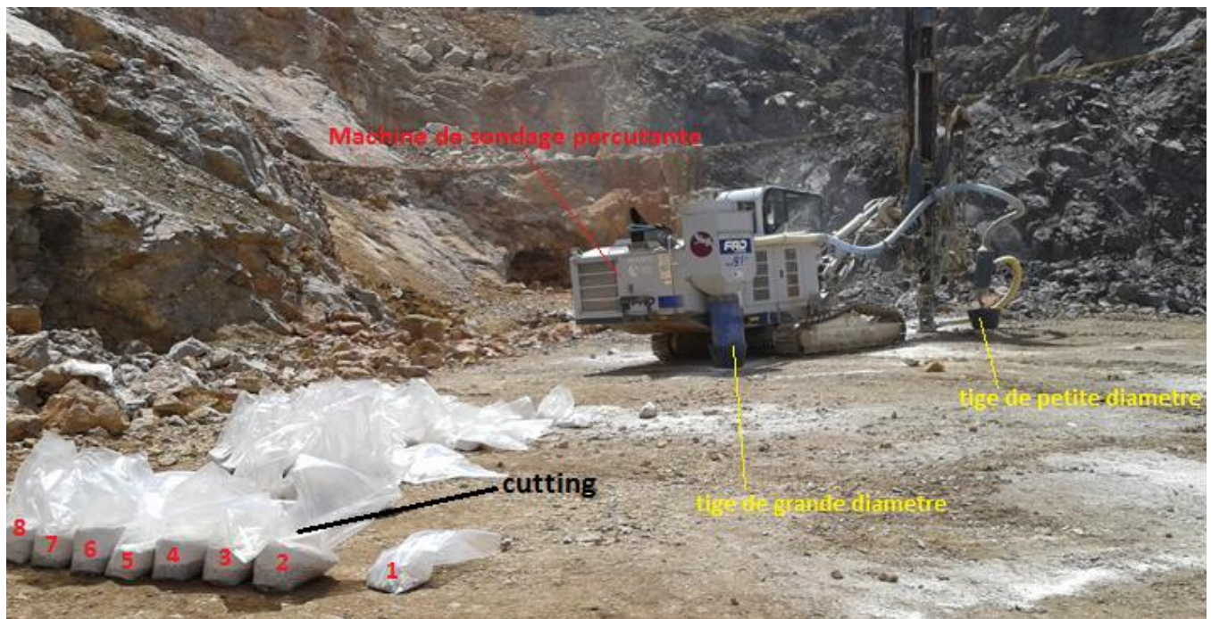
Figure II. 20 : Machine de sondage percutant RC et échantillonnages.
