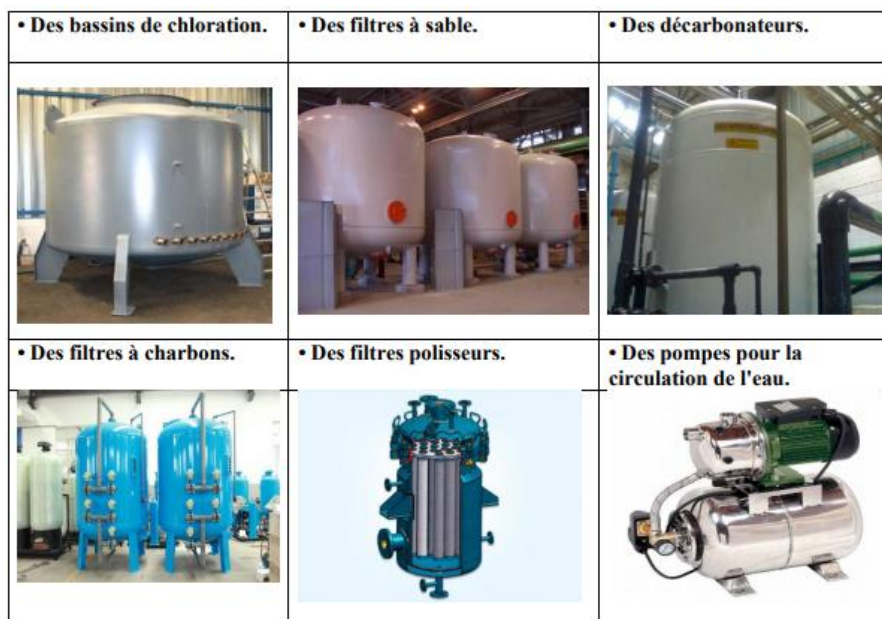
Figure 3 : Ensemble des filtres utilisés dans le traitement des eaux.
