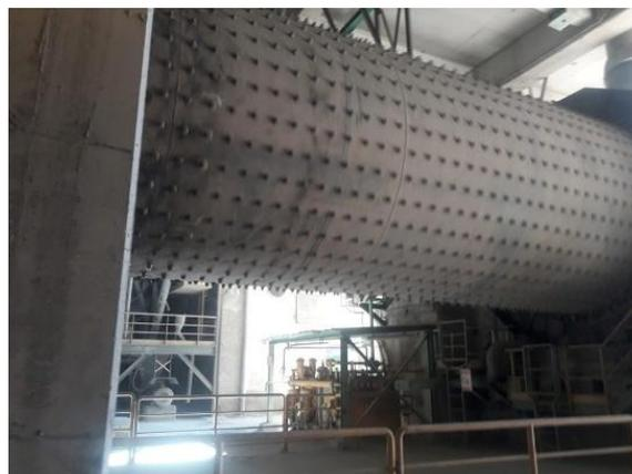
Figure 7 : broyeur clinker
