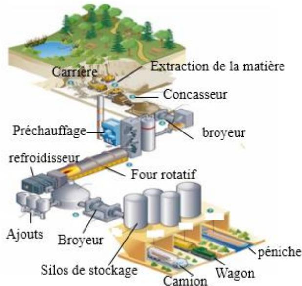
Figure 3 ; processus de fabrication de ciment
