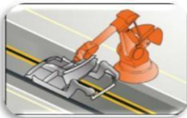
Assemblage de l'armature
