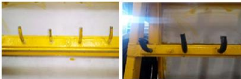
Figure 57: l'état avant et après des crochets du chariot du BDT
