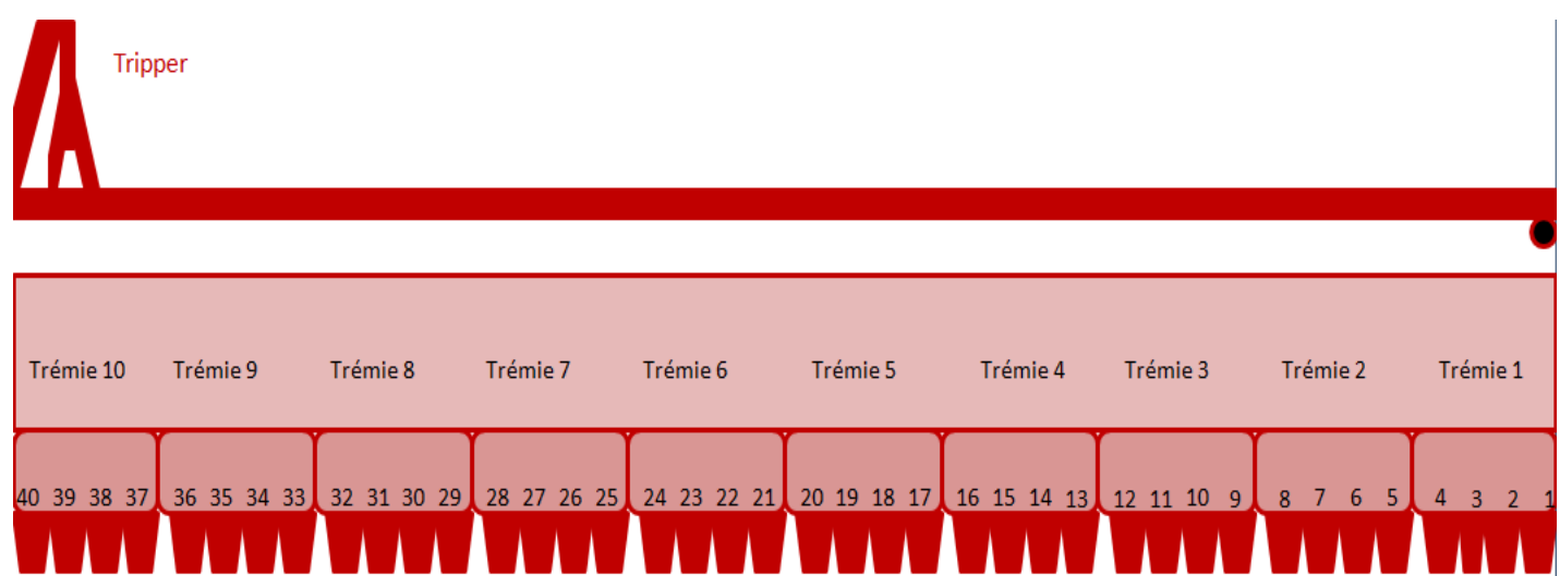
Figure 9: Schéma global de la structure mécanique entraînée par le circuit pneumatique
