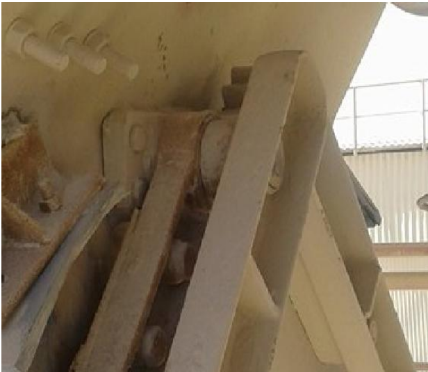
Figure 40 : Les dentures de l'une des bras sont annulées
