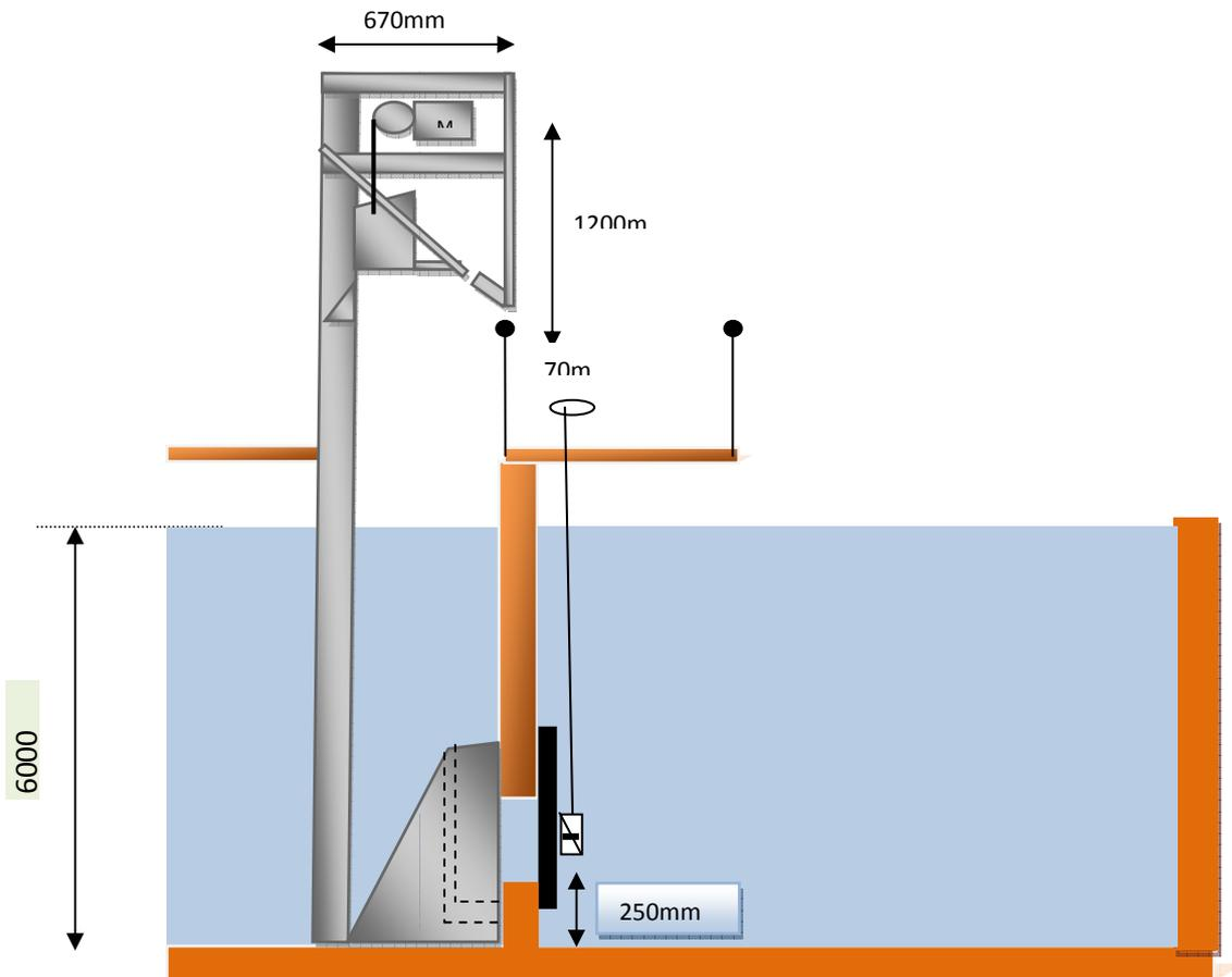
**Figure XIX : Positionnement du dégrilleur**
