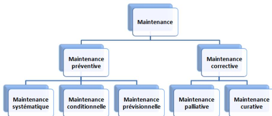
**Figure III : Les différentes formes de la maintenance**
