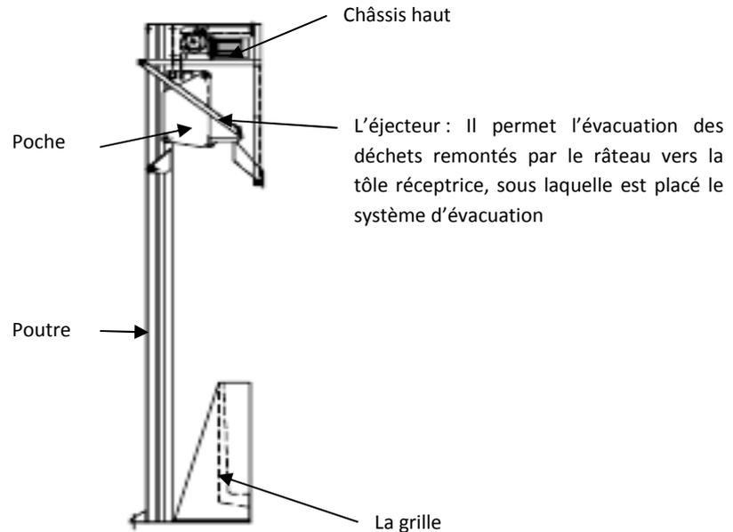
**Figure XVII : Dessin d'ensemble du dégrilleur**
