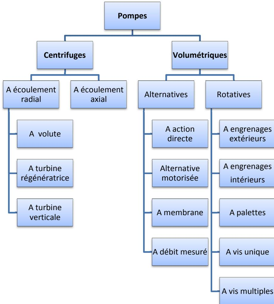
Figure IV : Classification des pompes
