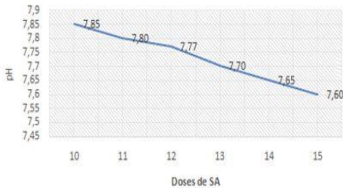
Figure 17 : Courbe de variation de pH en fonction de sulfate d'aluminium
