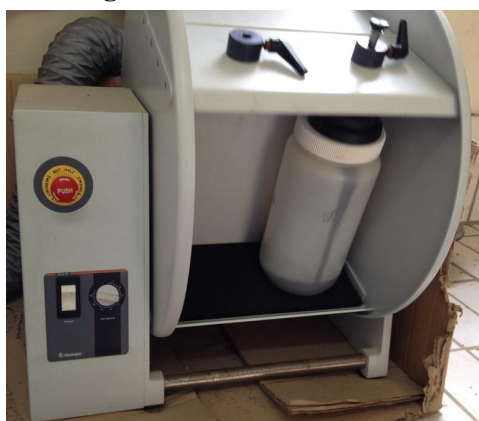
Figure 28 : Agitateur mécanique à mouvement horizontale
