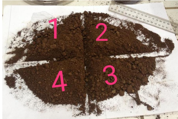
Figure 22 : Quartage par la méthode du cône
