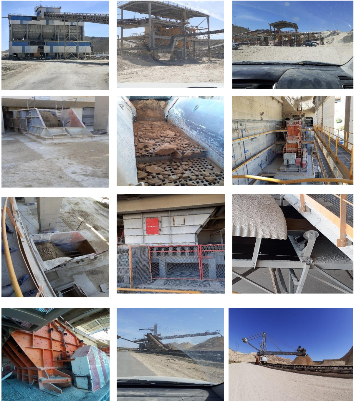
Figure 15: Les étapes d'épierreage, criblage jusqu'à la mise en stock.
