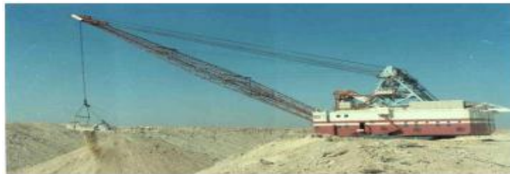
Figure 12: Décapage par Dragline.
