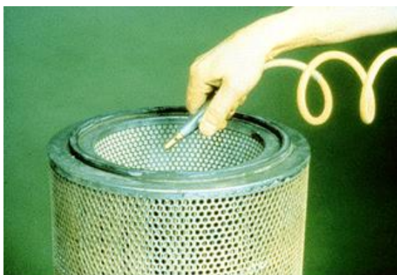
Figure26 : Nettoyage des filtres à air
