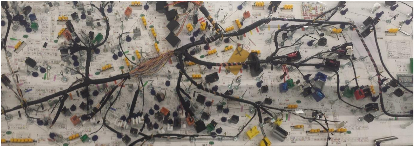
Figure 1.7 : JIG d'assemblage d'un câble
