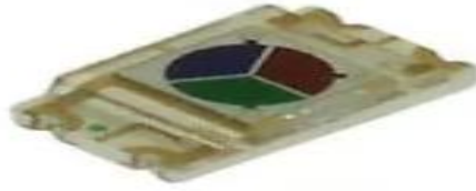
Figure 3.23 : Capteur de couleur
