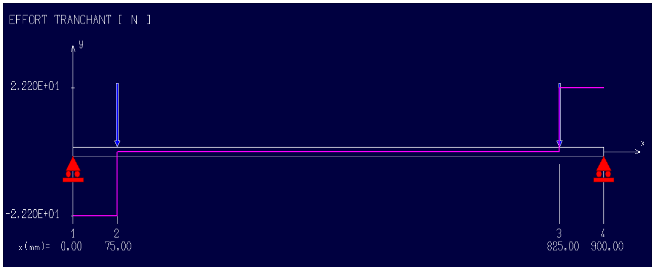
Figure 56 : Effort tranchant dans le plan (x,y) par RDM6
