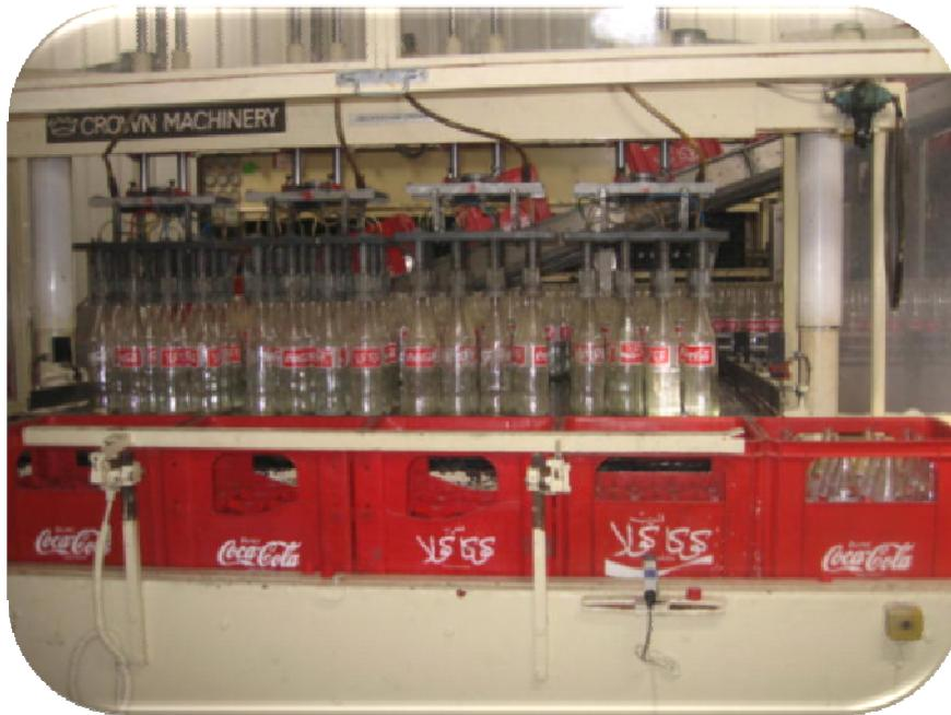
Figure n°5 : décaisseuse
