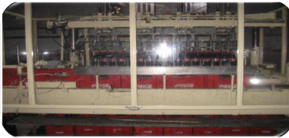
Figure n°12 : encaisseuse
