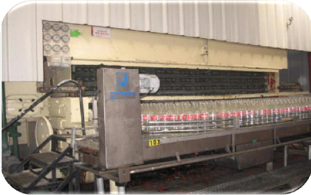
Figure n°6 : laveuse de bouteilles
