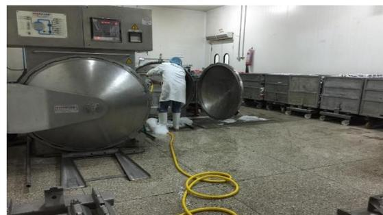
Figure 16: Détartrage de l'autoclave
