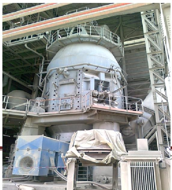
de broyage comprend le broyeur, le séparateur (qui sélectionne les particules selon leur grosseur), le dépoussiéreur du broyeur et accessoirement la presse à rouleaux.
