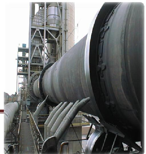
des stations de roulement, il est garni intérieurement par des produits réfractaires. Durant la cuisson, le four rotatif est animé d'un mouvement de rotation, la disposition en pente du four permet le mouvement de la matière première qui est injectée de l'autre extrémité par rapport à la flamme de chauffe. Durant ce déplacement, la matière se transforme par cuisson tout en avançant de son état initial jusqu'à ce qu'elle devienne « clinkérisée » à la température de 1450°C.
