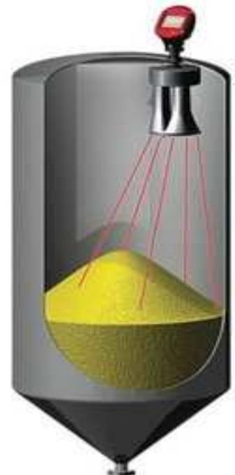
**Figure 33: Capteur de niveau acoustique**
