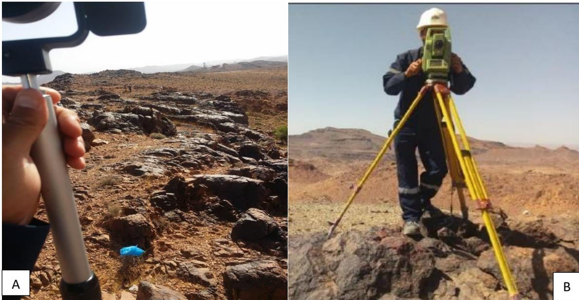
Photo 2 : Levé géométrique des Karkours. A : Jalonne. B : Tachéomètre Leica 509 (station totale).
